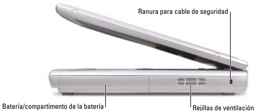
**BATERÍA/COMPARTIMENTO DE LA BATERÍA** — Si tiene instalada una batería, puede utilizar el equipo sin conectarlo a una toma de corriente. Consulte la página 27.
