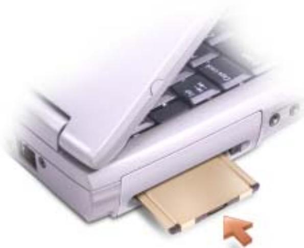
El equipo reconoce la mayoría de las PC Card y carga automáticamente el controlador de dispositivos adecuado. Si el programa de configuración le pide que cargue los controladores del fabricante, utilice el disco o el CD incluido con la PC Card.
